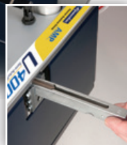
Accès postérieur simplifié pour l'insertion des chargeurs d'agrafes, et leur changement
