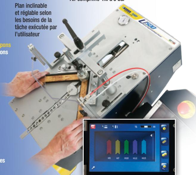
PC avec écran tactile, possibilité de mémoriser jusqu'à 5000 programmes d'assemblage
