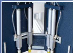
La T-400 est munie de 4 pistons pneumatiques bloquant la baguette par le haut pendant la coupe
