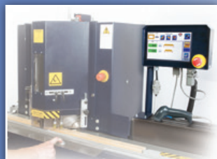
La T-400 est munie de 4 pistons pneumatiques bloquant la baguette par le haut pendant la coupe
