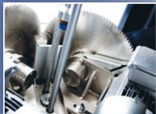
Vue du système pneumatique de contrôle de descente/montée des lames
