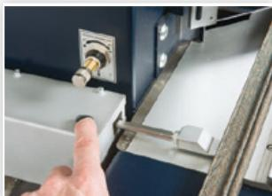
Le système de mesure automatique de la largeur mesure la largeur de la baguette et la mémorise automatiquement pour l'exécution du travail en cours (accessoire en option).
